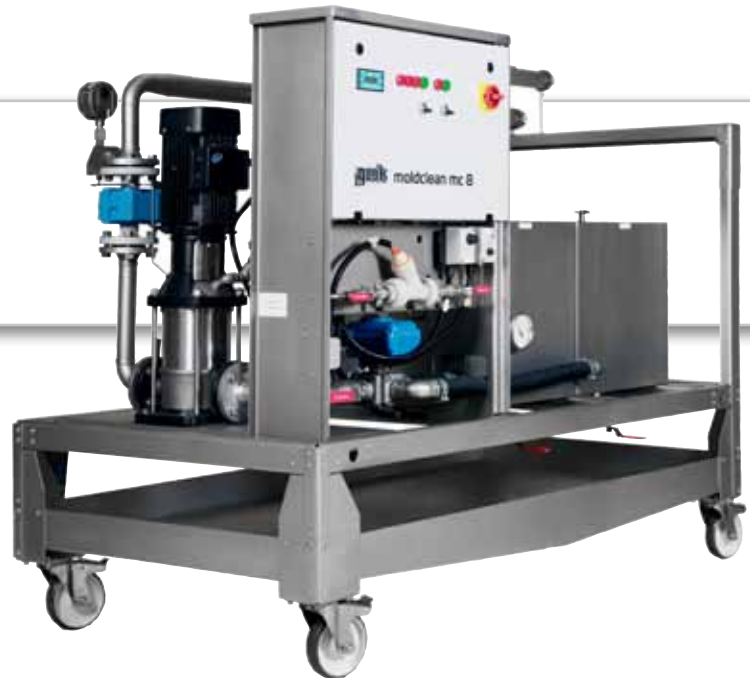
gwk moldclean mc 8: Инновационное решение для очистки пресс-форм до 8 контуров одновременно
