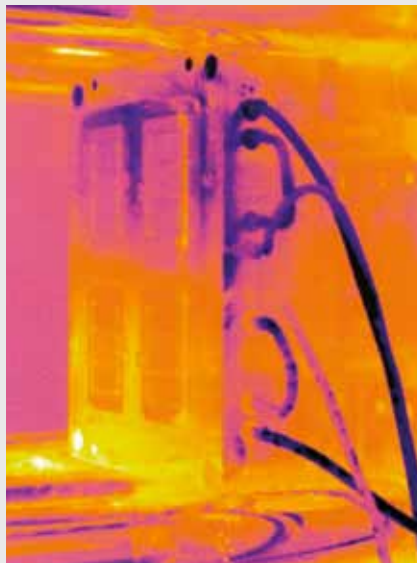
Répartition non uniforme de température dans un outillage en raison de l'encrassement des circuits de refroidissement.
