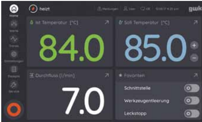
Дисплей и пульт управления logotherm с понятным сенсорным 7-ми дюймовым дисплеем
