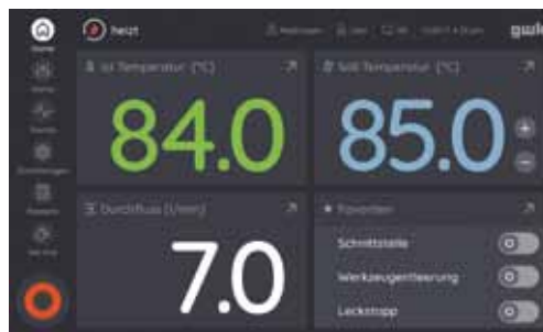
Anzeige und Bedieneinheit logotherm mit anwenderfreundlichem 7-Zoll-Touchscreen
