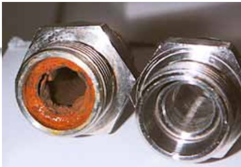
Produktivität erhöhen durch Reinigung und Schutz der Temperierkanäle
