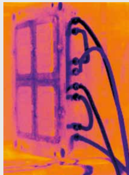
Distribuzione omogenea della temperatura nello stampo dopo la pulizia dei circuiti di condizionamento.
