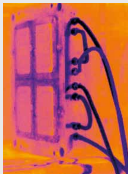
Homogenní rozložení teplot ve vstřikovací formě po vyčištění temperačních okruhů.
