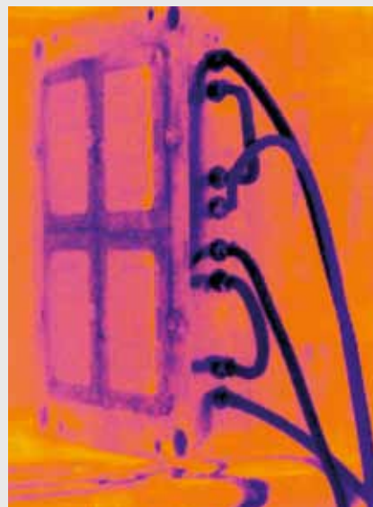
Равномерное распределение температуры в форме при литье после чистки контуров терпериования.
