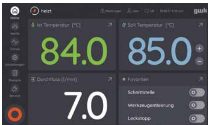
Unidad de indicación y manejo 'logotherm' con pantalla táctil cómoda de manejo de 7 pulgadas
