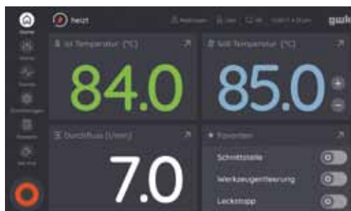
Ukazatel a ovládací jednotka Logotherm s uživatelsky příjemnou 7palcovou dotykovou obrazovkou
