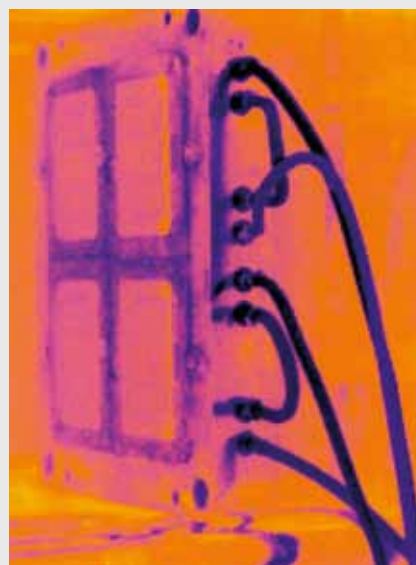
Равномерное распределение температуры в форме при литье после чистки контуров темперирования.
