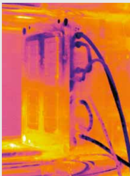
Неравномерное распределение температуры в форме при литье по причине загрязнённости контуров темперирования.
