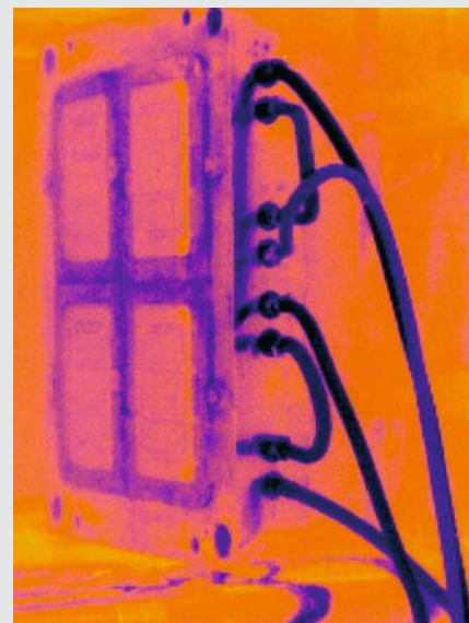
Répartition homogène de la température dans l'outillage après nettoyage des circuits de refroidissement.
